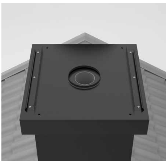
21. Montera taket med 4 st LP-skruv 4,8×35.
